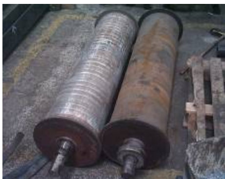
Rodillo reparado / Rodillo dañado
